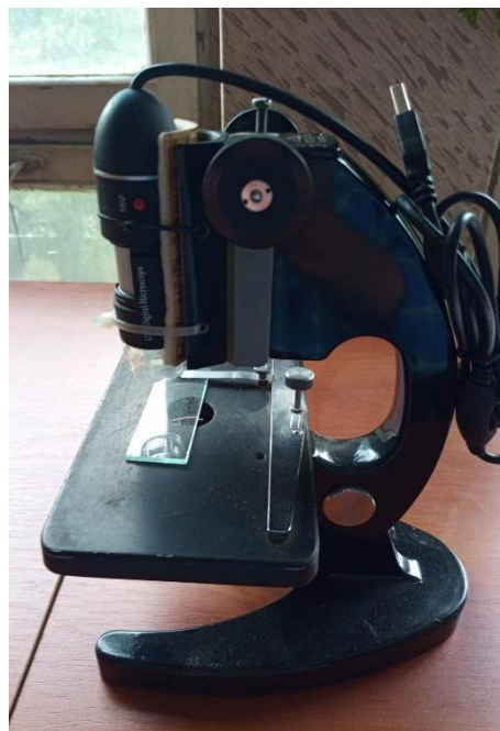
Рис. 8. Цифровий мікроскоп (а), що закріплено на основі біологічного мікроскопу (б)
